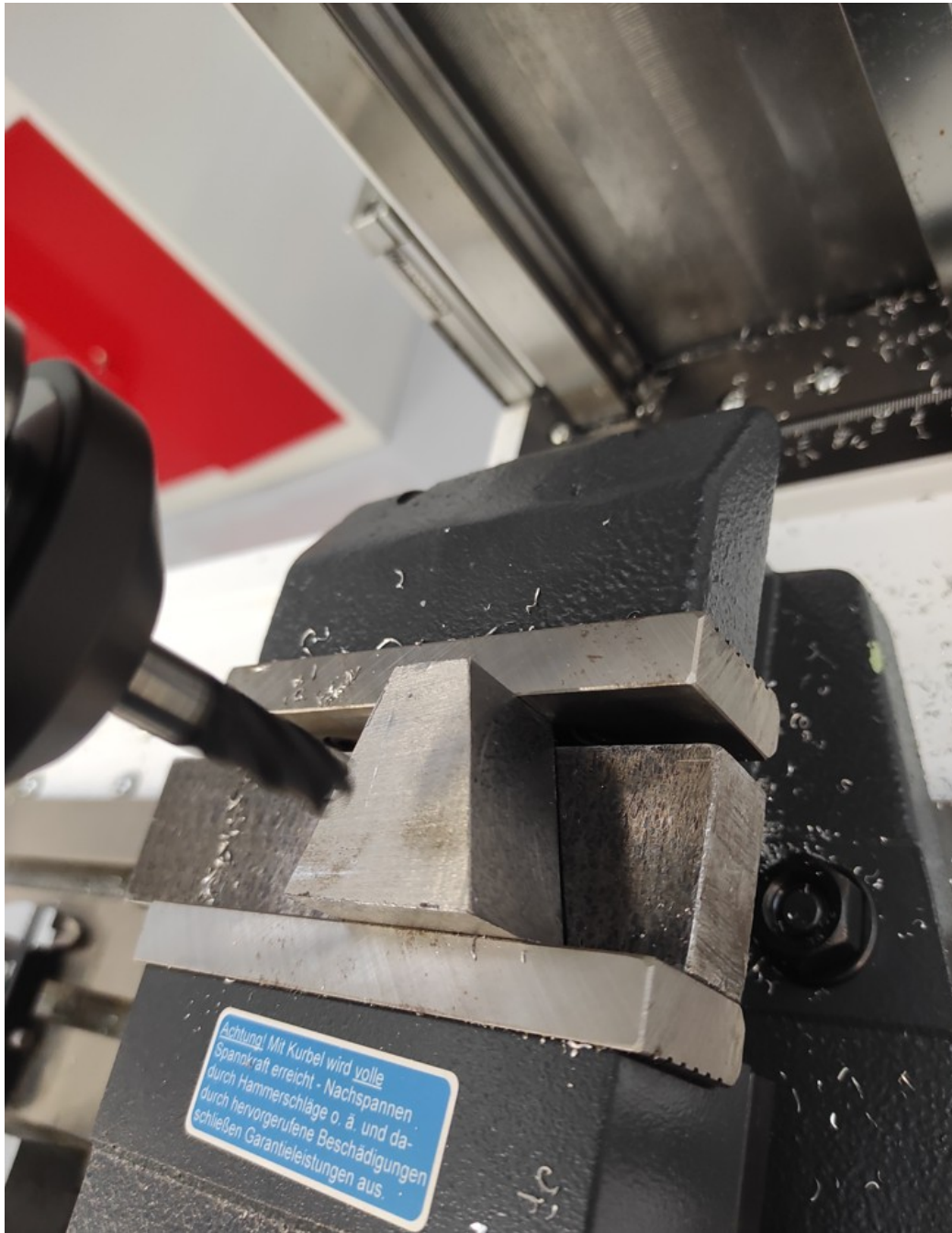
Obr. 30 Frézovanie šikmej plochy
