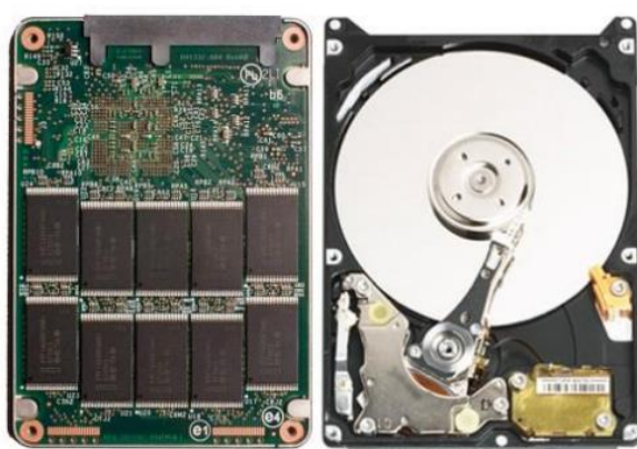
Obr. 1.1 SSD v porovnaní s HDD
